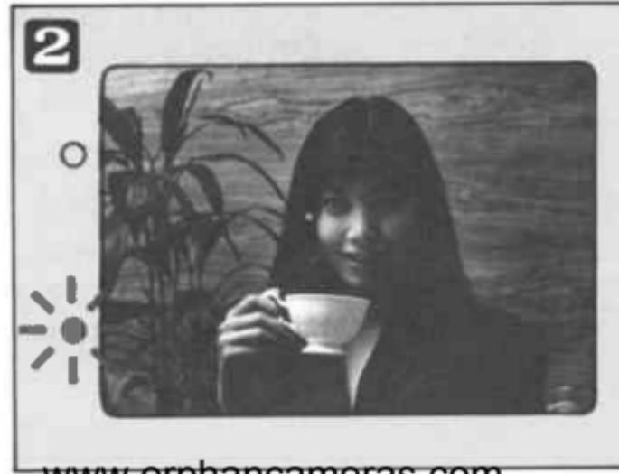
[F] S'il n'y a pas assez de lumière, l'indicateur de flash (orange) s'allume quand le déclencheur est légèrement pressé. Appuyer complètement sur le déclencheur pour prendre une photo avec le flash.
